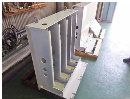
鋼製壁高欄本体
