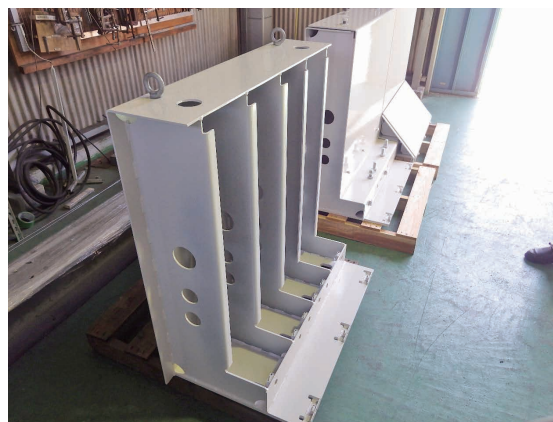
鋼製壁高欄本体
